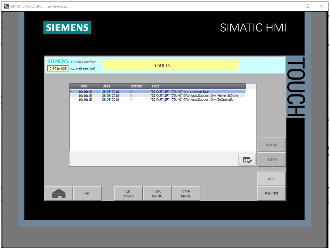
7.5 Abbild 05: HMI Störung- und Warnungsfenster. Eine Störung [!] und zwei Warnungen.
