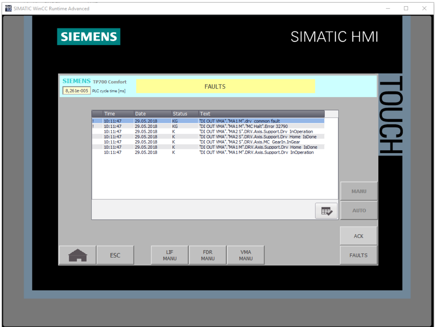
7.6 Abbild 05: HMI Störung- und Warnungsfenster. Zwei quitierte Störungen (!) und fünf Warnungen. Error 32790 beim „MC Halt“ (8016 hex) bedeutet: Die Istwerte sind nicht gültig.
